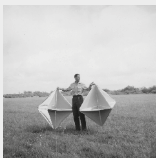
Préparation des réflecteurs radar avant le lâcher d'un ballon
